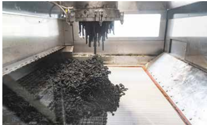
Nanos dehidriranega blata na sušilni trak prek matrice.
